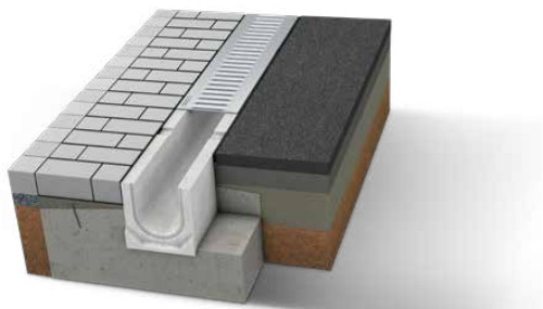
Bild 1: Entwässerungsrinne BIRCOplus aus Beton
