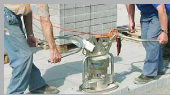
SPEEDY VAKUUMVERSETZGERÄT 230 V
