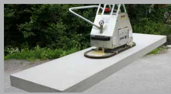
SM STEINMAGNET PLATTENVERLEGEGERÄT
