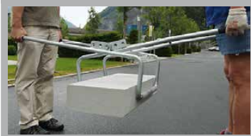
VERSETZZANGE TYP MULTIHEBER
