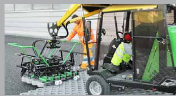
VERLEGEMASCHINEN FÜR VERBUND- UND PFLASTERSTEINE
