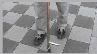
RICHTEISEN FÜR PFLASTER- UND VERBUNDSTEINE
