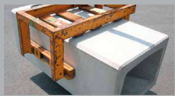
VERSETZZANGE FÜR VIERKANTELEMENTE
