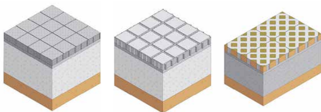
Bild 3: Gegenüberstellung Sicker-, Öko- und Rasengittersteine (v.l.n.r.)
