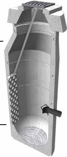
Coupe schématique AMFIX® Sortie amphibie intégrée dans un regard de chaussée
