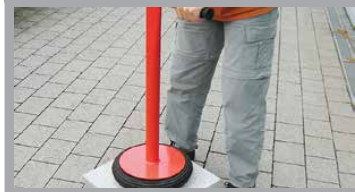
PORTE-DALLES PNEUMATIQUE PAR VIDE D'AIR
