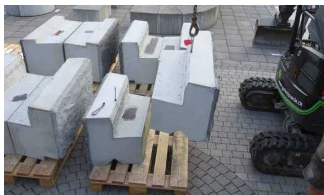
Illustration 21 : douilles de transport M16 montées en usine
