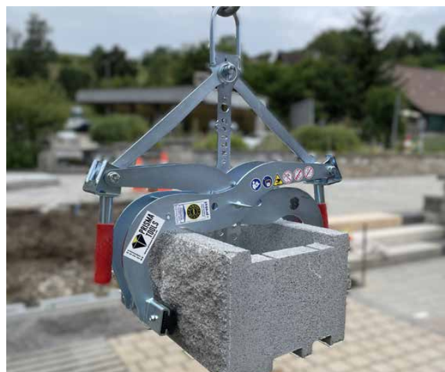
Illustration 5 : pose à l'aide de la pince TSZ-Uni
