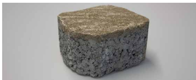
noyau en béton filtrant
