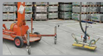
PLATTEX APPAREIL DE POSE POUR DALLES
